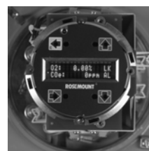
Корпус электронного блока с местным интерфейсом оператора
