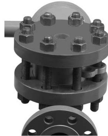
Рис. 12. Установка Fisher 249W завершена
