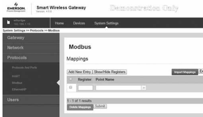
Рис.3. Экран соответствия регистров Modbus.
