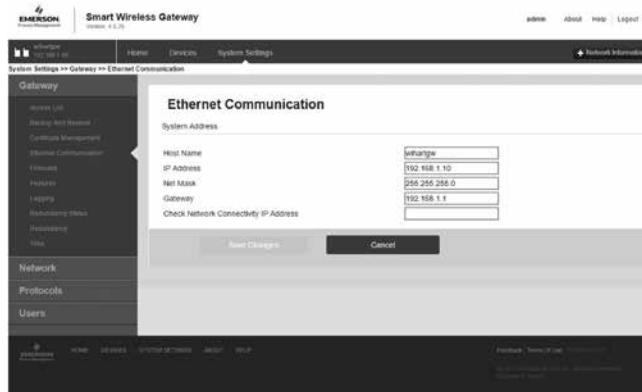
Рис.5. Окно беспроводного шлюза 1420 в интернет браузере.
