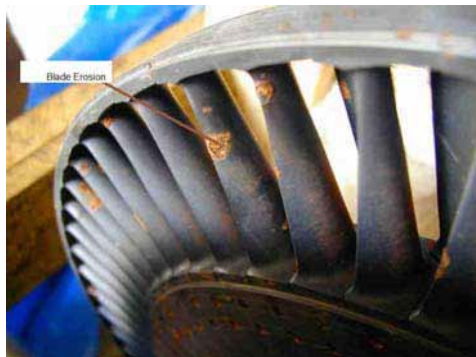
Следы ударов капель жидкости о лопатки турбины
