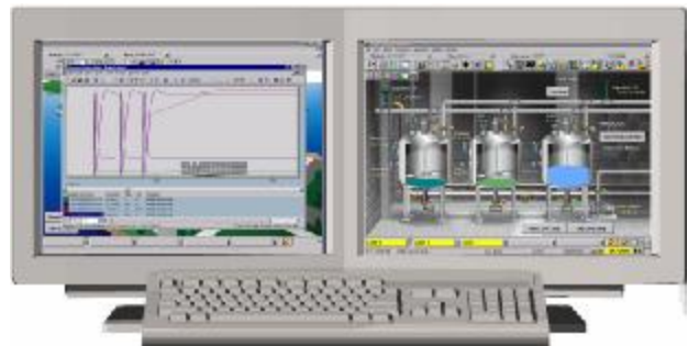
Просмотр трендов процесса без перекрытия дисплея оператора.
