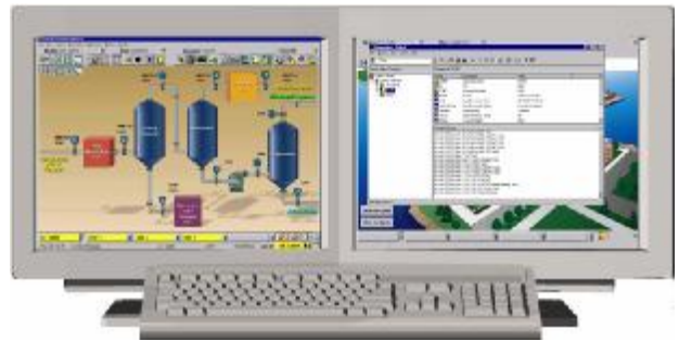
Программа Диагностики или Студия Управления могут вызываться на отдельный экран, не перекрывая операторские мнемосхемы. Одним нажатием кнопки мыши можно менять местами изображение на экранах.
