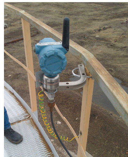
Установка беспроводного датчика давления Rosemount 3051S
