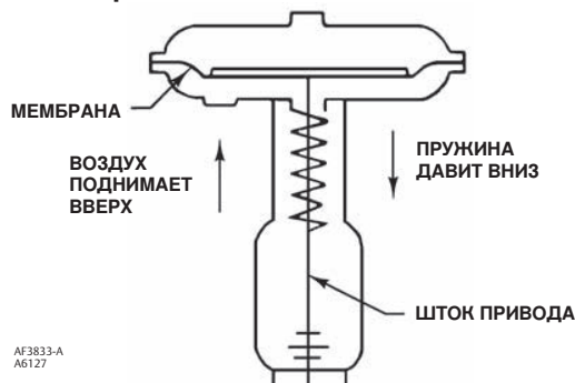
МЕМБРАНЫЙ ПРИВОД МОДЕЛИ 667 ОБРАТНОГО ДЕЙСТВИЯ
