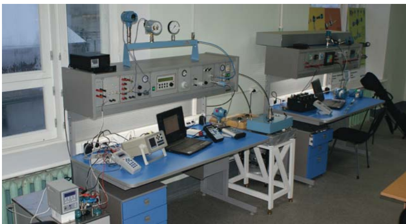
Фото 1. Универсальный стенд с использованием калибраторов и эталонов для поверки средств измерений в радиомеханическом техникуме в г.Йошкар-Ола
