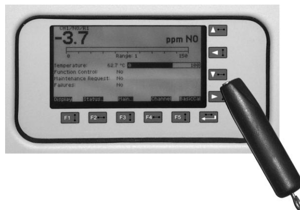
Рисунок 3. Магнитоуправляемая передняя панель с защитным стеклом и инструментом
