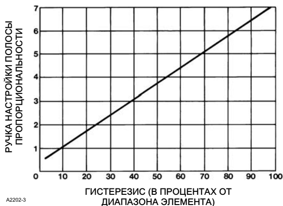
Рис. 10. Регулировка гистерезиса в регуляторах с гистерезисом
