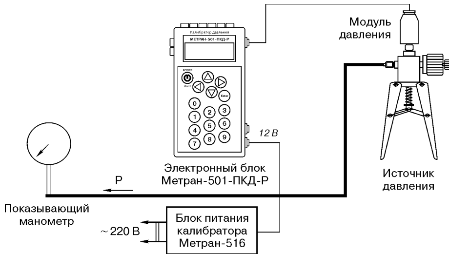
Рис. 5. Поверка и калибровка показывающих манометров.
