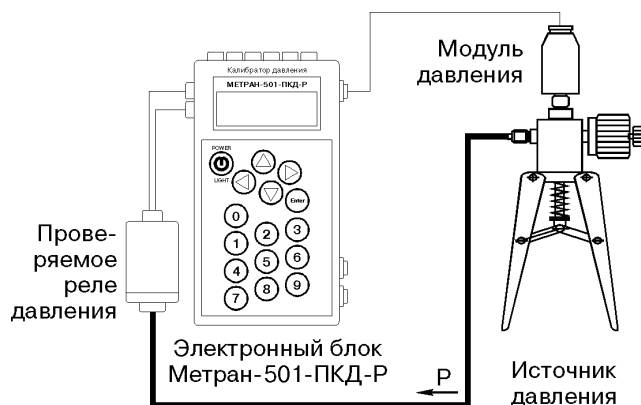
Рис. 3. Проверка реле давления.
