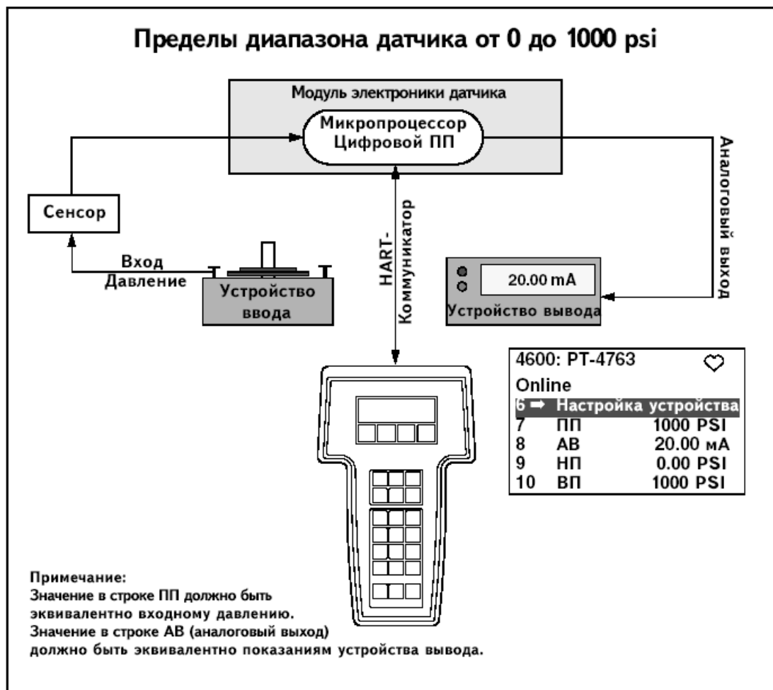
Рисунок 4-1. Поток данных датчика с вариантами калибровки
