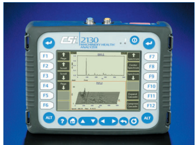
На каскадном графике отображаются спектры вибрации, зафиксированные во время запуска или останова машины. Вверху экрана показан индивидуальный спектр, внизу – каскад спектров.
