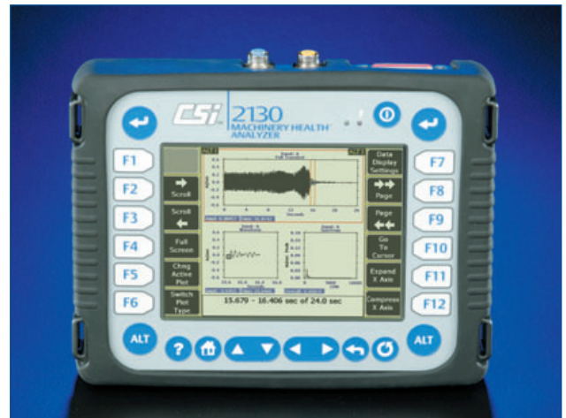
Программа транзистентного анализа фиксирует вибро сигналы процессов запуска-останова машины для последующего тщательного анализа.
