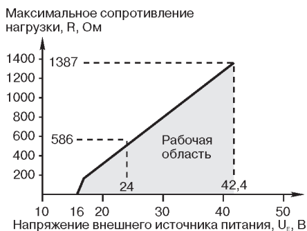
Рис. 15. Диаграмма сопротивлений для уровнемера в безопасной зоне.
