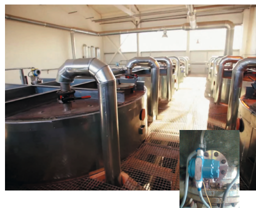
Измерение уровня среды в реакторе (вверху и внизу колонны) в отделении оксиэтилирования
