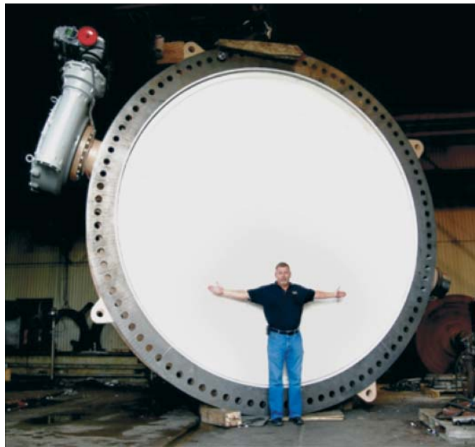
▲ Рис. 1. Электропривод для управления дисковым затвором Bettis, Emerson Process Management
