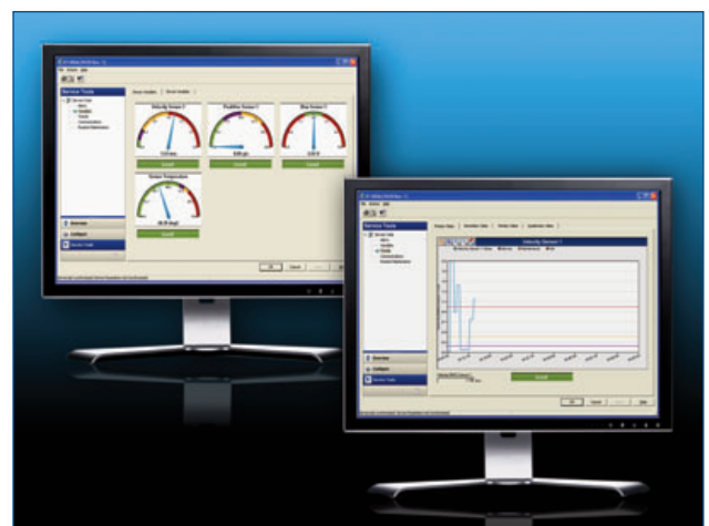
AMS Device Manager používa jazyk EDDL na vytvorenie okna predstavujúceho panel zariadenia s jasnou indikáciou stavu prístroja a zariadenia
