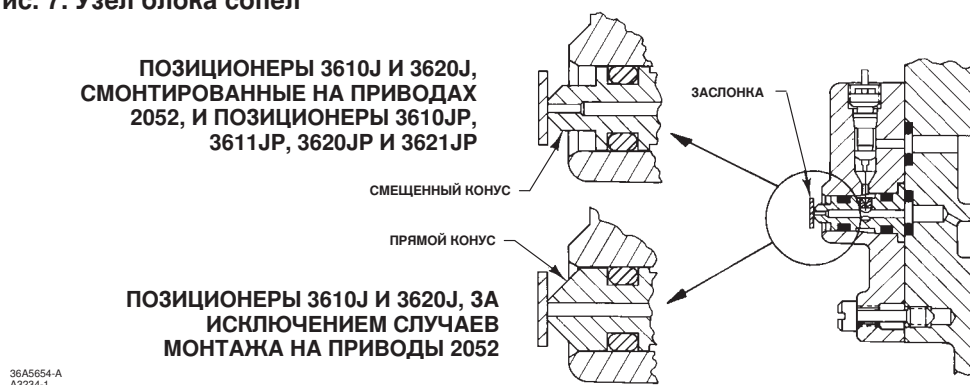
Рис. 7. Узел блока сопел
