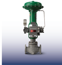
Серия easy-e™ универсальная Модели ES, ED, ET, EZ, EWT, EWD Размеры DN25...200 / NPS 1...8 дюйма Номинальное давление PN16...40 / Class 150...600 Углеродистая сталь WCC, WCC HT, LCC, нержавеющая сталь CF8M
