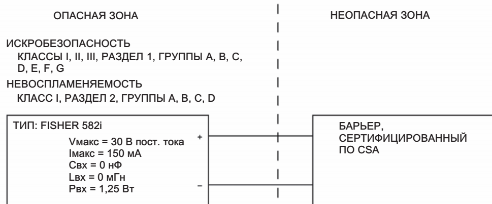
Рис. 28. Схема контура по стандарту CSA для преобразователя Fisher 582i (установочный чертеж GE28591)
