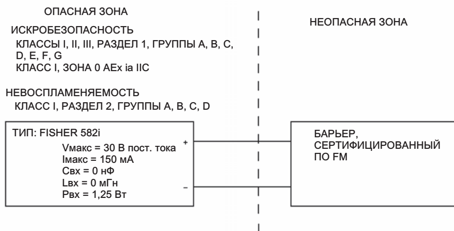
Рис. 29. Схема контура по стандарту FM для преобразователя Fisher 582i (установочный чертеж GE28590)
