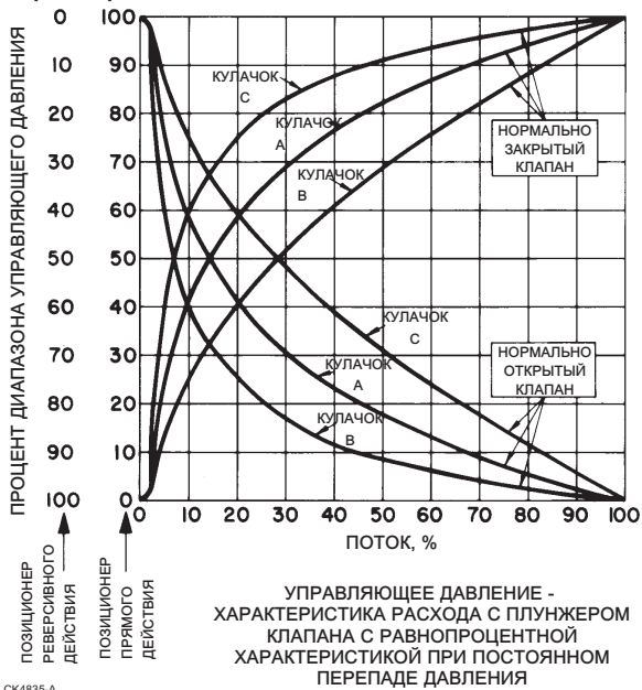
Рис. 13. Регулировочная характеристика потока при использовании различных кулачков и плунжера клапана с равнопроцентной характеристикой
