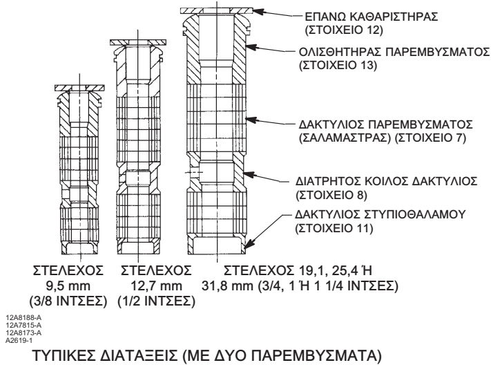
Σχήμα 4. Λεπτομέρεια διατάξεων παρεμβύσματος από PTFE/σύνθετη ένωση Fisher
