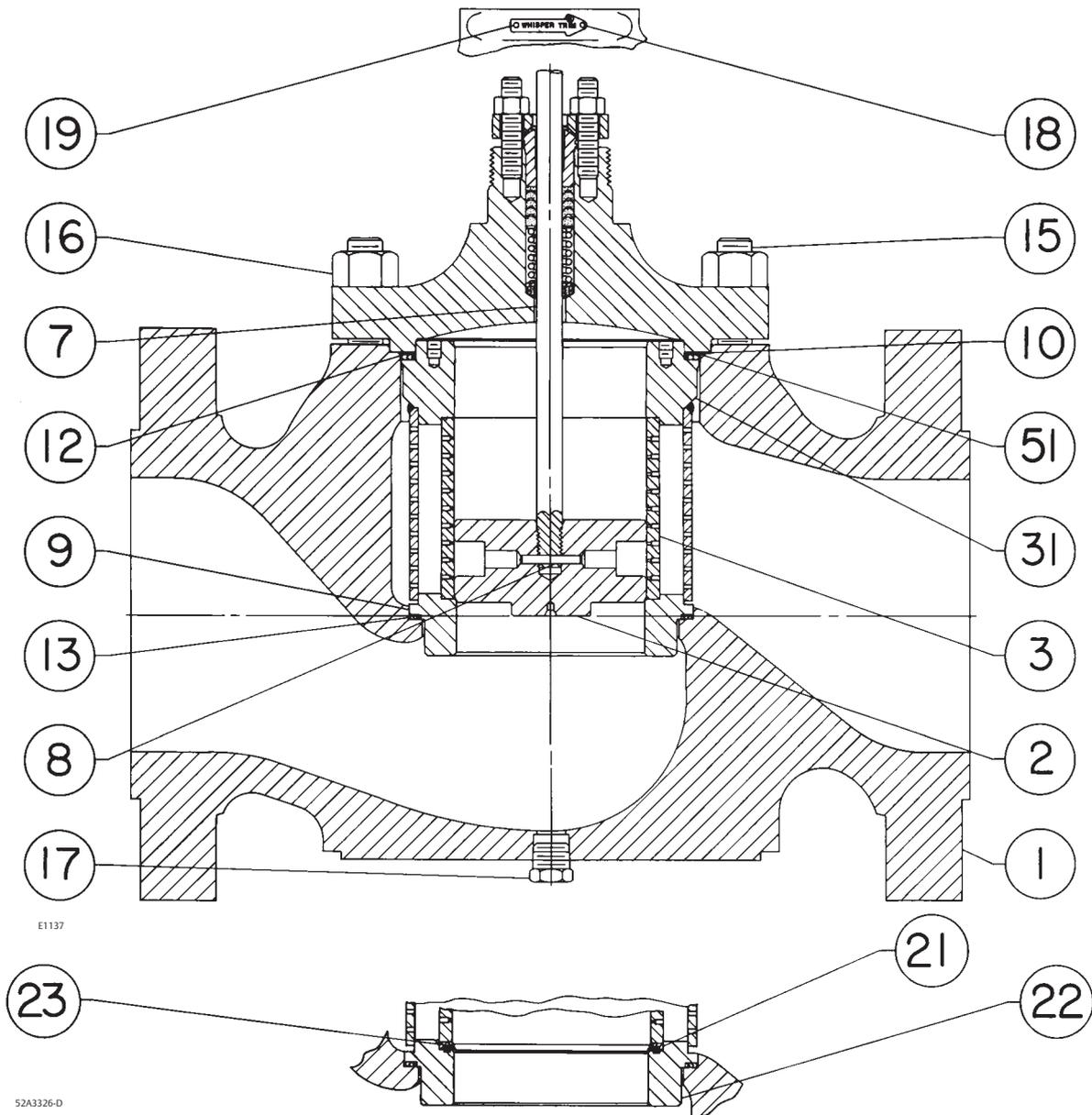
Abbildung 16. Fisher Ventil ES mit WhisperFlo Käfig mit optionaler Ablassschraube
