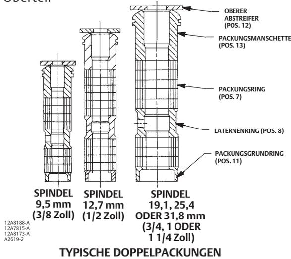
Abbildung 6. Doppelte Graphitband-/Graphitfaserpackungen für den Einsatz in ENVIRO-SEAL Faltenbalg-Oberteilen
