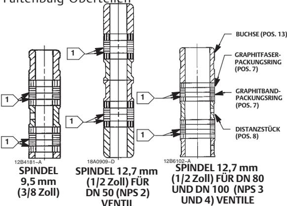
1 HINWEIS: KORROSIONSSCHUTZ-ZINKSCHEIBEN MIT 0,102 mm (0,004 Zoll) DICKE: NUR EINE UNTER JEDEM GRAPHITBANDRING VERWENDEN.
