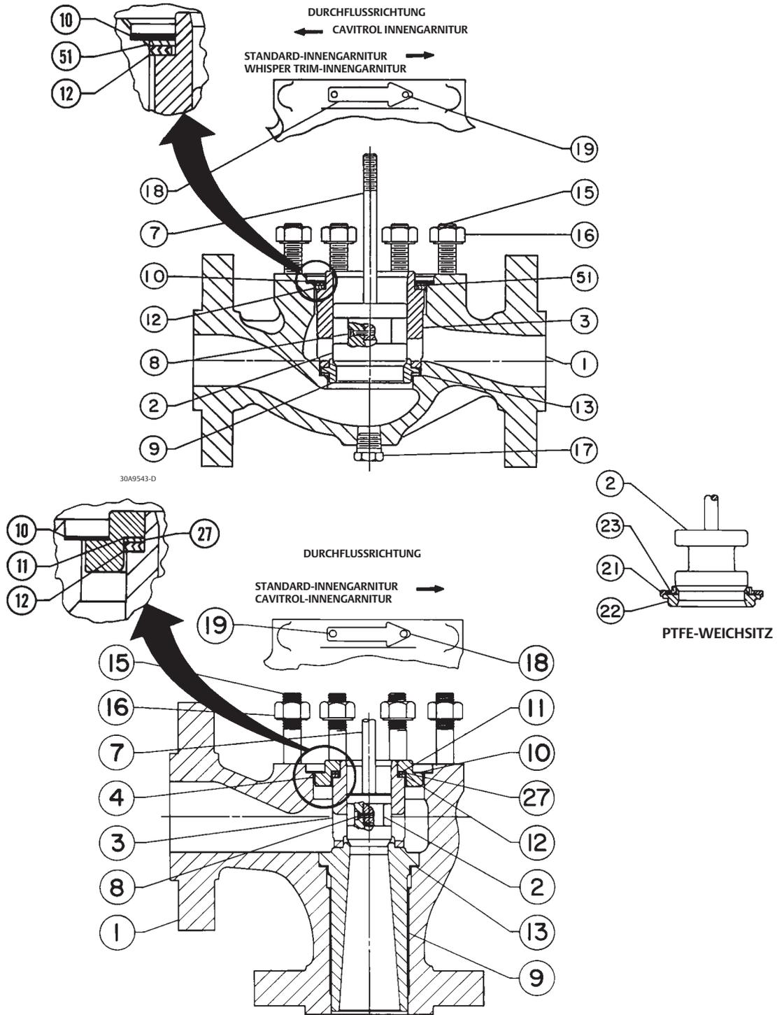
Abbildung 14. Fisher Ventil ES NPS 8 mit optionaler Ablasschraube
