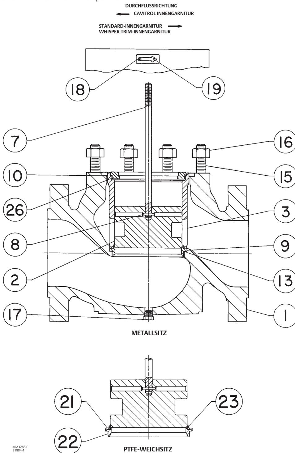
Abbildung 15. Detailansicht Whisper Trim III Käfig mit optionaler Ablasschraube
