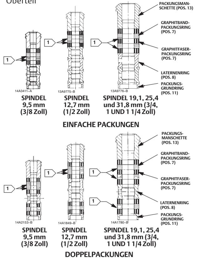
1 HINWEIS: KORROSIONSSCHUTZ-ZINKSCHEIBEN MIT 0,102 mm (0,004 Zoll) DICKE: NUR EINE UNTER JEDEM GRAPHITBANDRING VERWENDEN.
