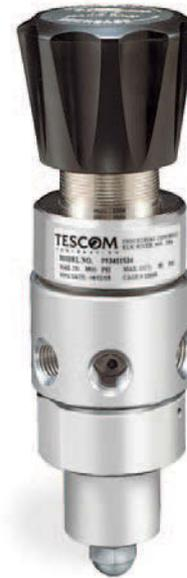
Die TESCOM-Serie PS-3400 sind kompakte, zweistufige Flaschendruckminderer für Ultrareinstgase mit befestigten Membranen für geringe Durchflüsse von giftigen, brennbaren und brandfördernden Gasen. Die diffusionsdichte Metallmembranabdichtung ist der Garant für Gasreinheit und Dichtigkeit.
