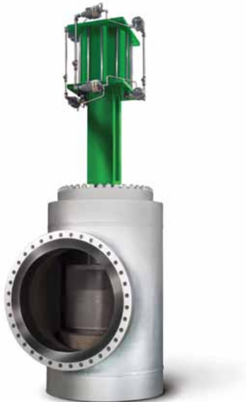
Ein geräuschminderndes Fisher Stellventil kann speziell für die Anforderungen Ihrer Anwendung gefertigt werden. Das oben abgebildete Stellventil hat die Nennweite NPS 36 x 42 und enthält einen Fisher Whisper Trim III Käfig.
