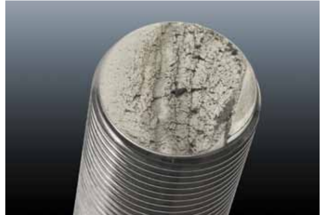
Ein häufig auftretender Defekt, der von starken Vibrationen im System verursacht wird, ist der Ermüdungsbruch der Ventilspindel oder der Ventilwelle.
