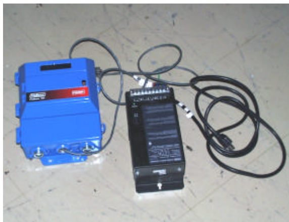
Foto 1 – Computador de Vazão modelo Floboss 407
