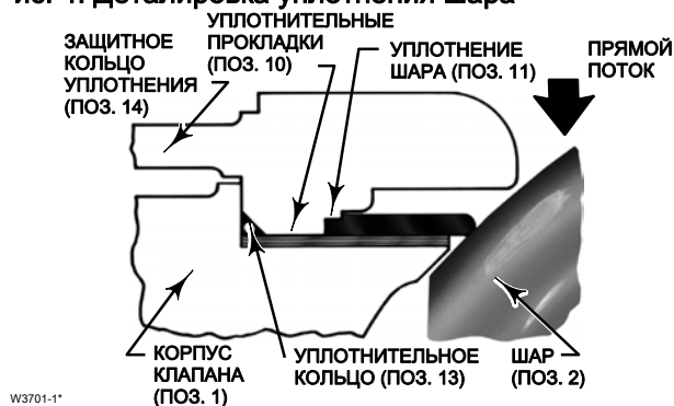
Рис. 4. Детализовка уплотнения шара
