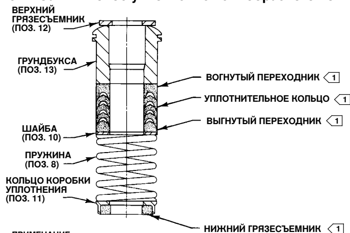
Рис. 2. Сальниковое уплотнение из V-образного кольца из ПТФЭ
