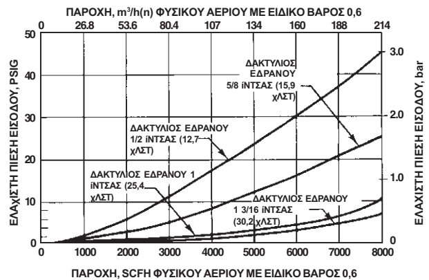
Σχήμα 1. Απαιτείται μια ελάχιστη πίεση εισόδου για να αποφευχθεί η διακοπή όλων των μεγεθών ρυθμιστών S204, S204H, S206 και S206H στις υποδεικνυόμενες ροές.
