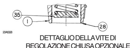
DETTAGLIO DELLA VITE DI REGOLAZIONE CHIUSA OPZIONALE
