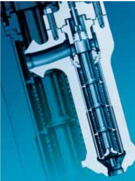
装有 Cavitrol IV 内件的 CAV4 型控制阀是专门为液体场合而设计的，用于压力降大于 3000psi 并产生气蚀问题的系统，如锅炉给水再循环系统。
