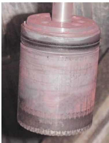
Foto 1. Corona dentada dañada (obturador de la válvula).
