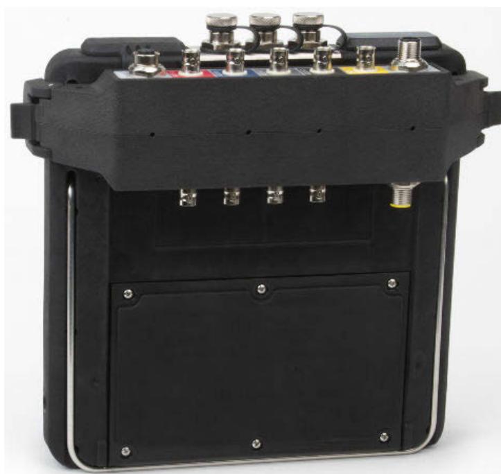
Figur 5: Ingångsadaptern med fyra kanaler ansluten till CSI 2140 utan gränssnittskabel
