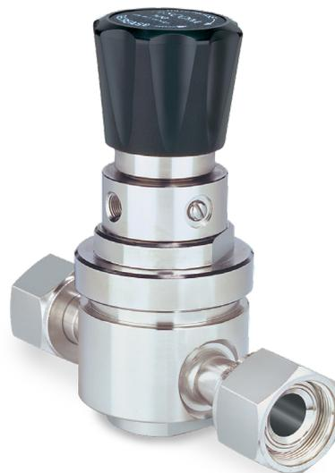
TESCOM 64-3200シリーズ超高純度/高流量ダイアフラム連結型減圧レギュレーターは、10 R<sub>a</sub>マイクロインチ / 0.25マイクロメートルの表面処理が施され、Hastelloy®トリムを選択できます。最大流量は31.8 SCFM / 900 SLPMで、入口圧力は1.03、6.89、10.3 MPa / 150、1000、1500 psig、出口圧力は1.38 MPa / 200 psigです。
