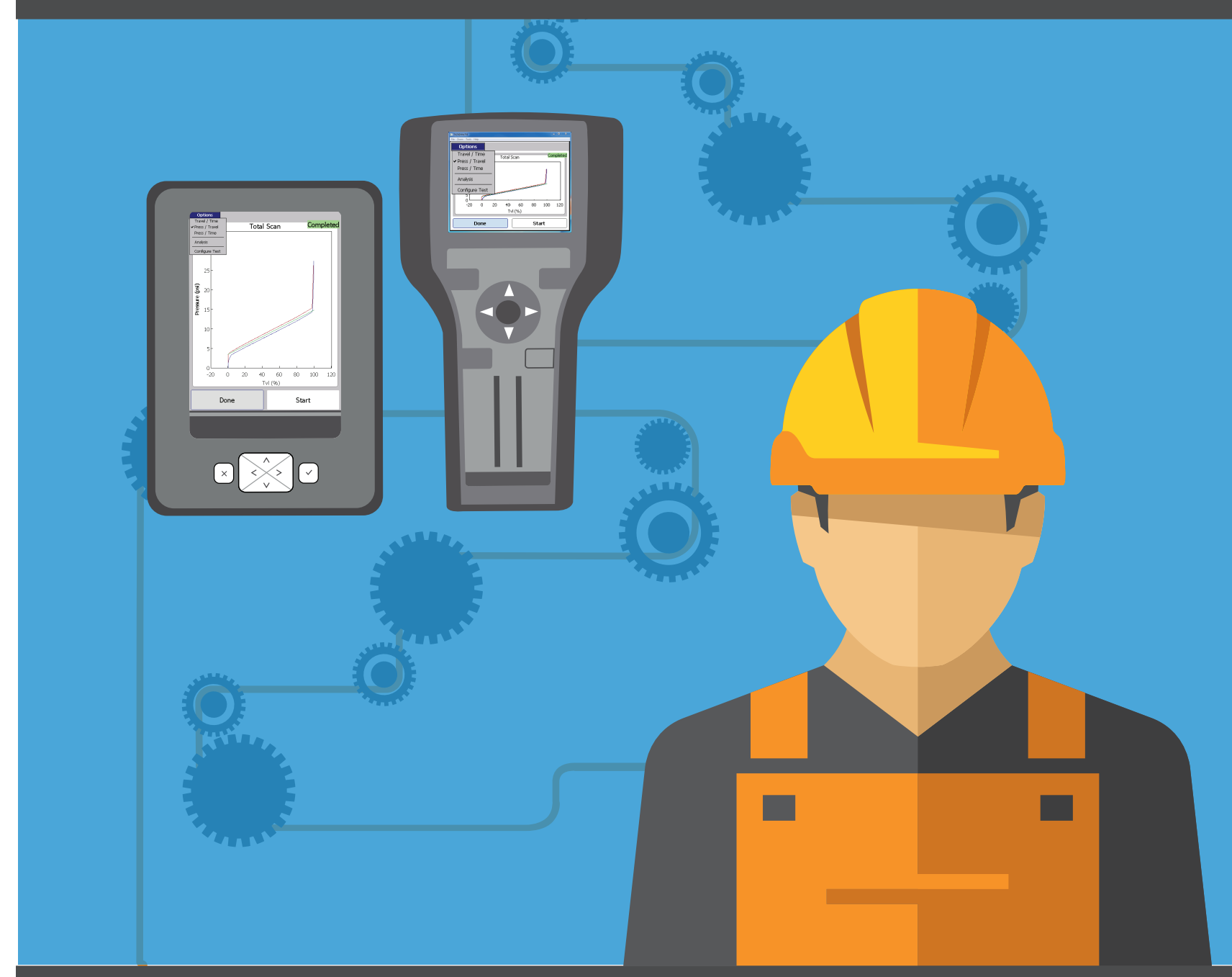
Diagnósticos Avançados permitem que você execute testes como Assinatura de Válvula, Resposta em degrau, entre outros - sem removê-la do processo.
