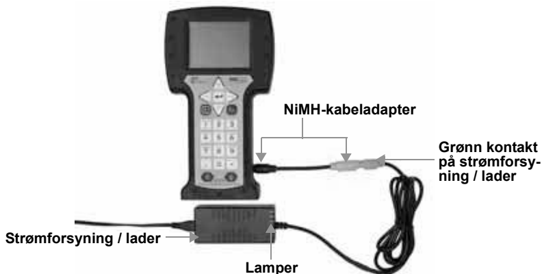
Figur 2. NiMH-kabeladapteren som brukes til å lade NiMH-batteripakken
