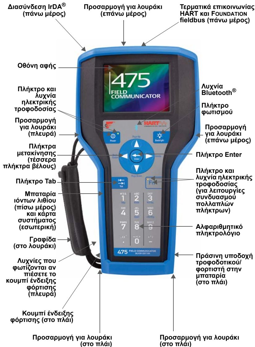
Σχήμα 1. Συσκευή Επικοινωνίας Πεδίου 475 με Προστατευτικό Ελαστικό Περιβλήμα
