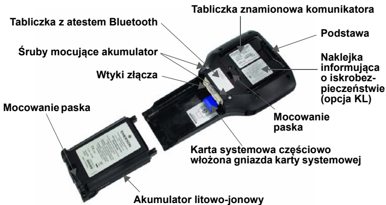
Ilustracja 2. Tylna ściana komunikatora polowego 475
