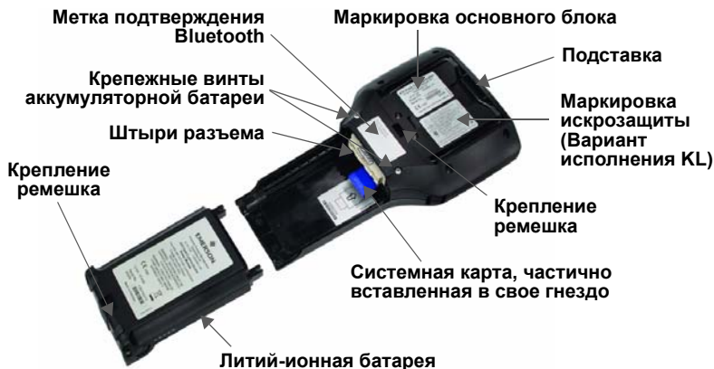
Рис. 2. Задняя сторона полевого коммуникатора 475
