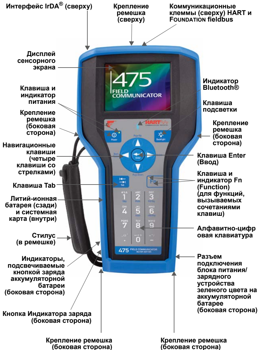
Рис. 1. Полевой коммуникатор 475 с защитным резиновым чехлом
