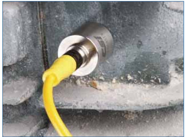
三向量加速度传感器可在测量位置同时从垂直、水平和轴向三个方向采集数据。
