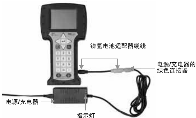
图 2. 用于为镍氢电池组充电的镍氢电池适配器缆线
