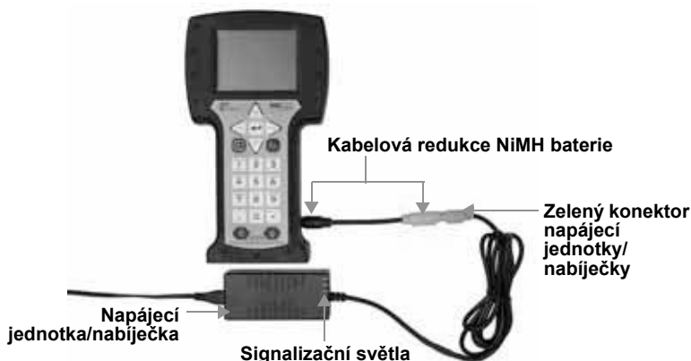
Obrázek 2. Kabelová redukce použitá k nabíjení baterie NiMH
