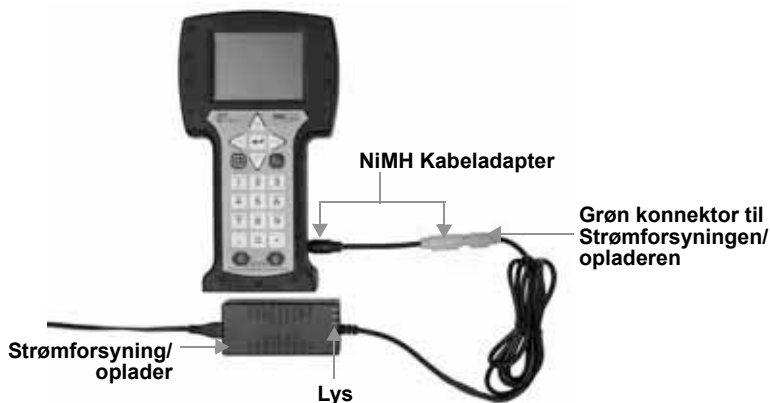
Figur 2. NiMH kabeladapter bruges til at oplade NiMH batteripakken
