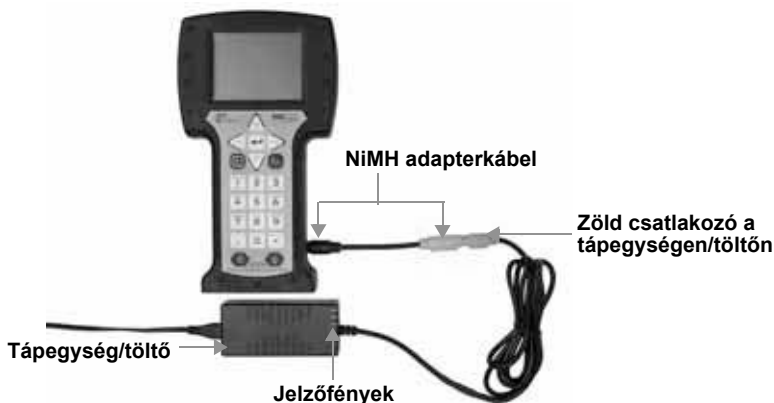
2. ábra A NiMH akkumulátorcsomag töltéséhez használt NiMH adapterkábel
