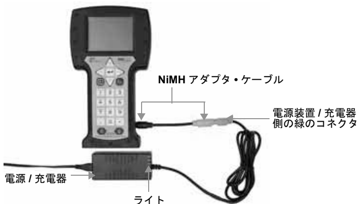
図 2. NiMH 電池パックを充電するために使用する NiMH アダプタ・ケーブル
