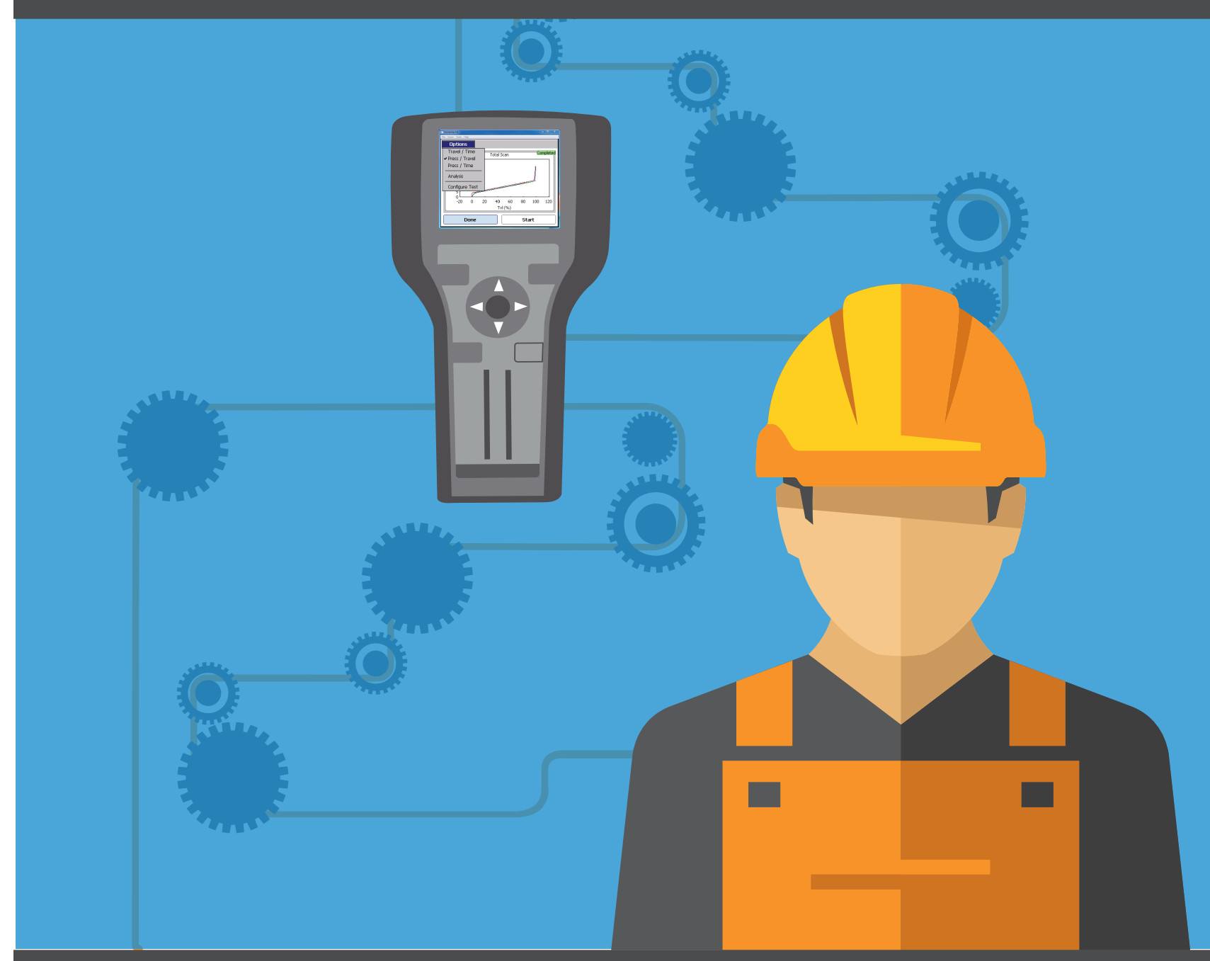
Mit der erweiterten Ventildiagnose können Tests, wie z. B. Total Scan, Step Response und Stroke Valve, direkt am Ventil durchgeführt werden, ohne es außer Betrieb zu nehmen.
