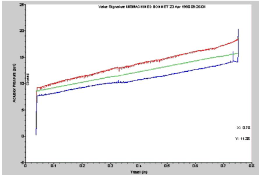
En el pasado, la detección de la fricción estática requería que se sacara de línea la válvula para realizar una prueba de impulso. Con la tecnología ValveLink, usted puede revisar si hay cambios en la firma mientras la válvula está en servicio, facilitando mucho más la detección de problemas antes de que afecten a la calidad del producto.
