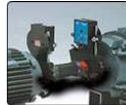
Instalación adecuada usando herramientas de alineación por láser
