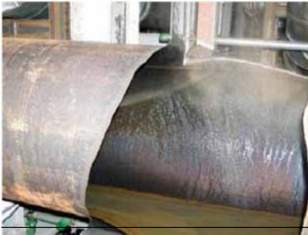
Kuva 3. Höyrylinjan repeytymä aiheutti neljän hengen kuoleman
