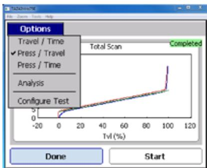
*Полное сканирование позволяет определить состояние седла, износ перемещающихся частей клапана.*
