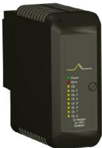
Плата традиционного в/в устанавливается в любой слот на несущей панели
